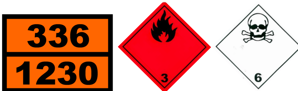
Figura 0.- Panel naranja para el metanol y sus etiquetas de peligro correspondientes.
