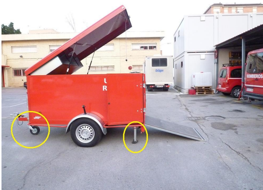
Figura 13- Remolque estabilizado y con la rampa de descarga desplegada.
