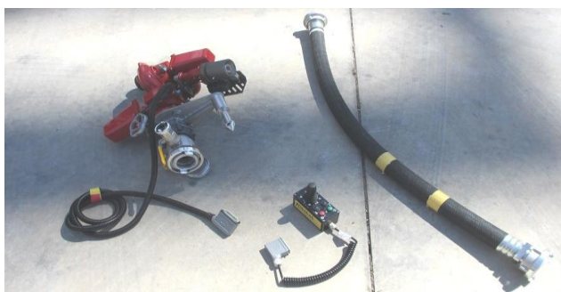
Figuras 2 y 3. Material necesario para la práctica, de izquierda a derecha: Monitor hidráulico, mangote semirrígido intermedio y mando de control del equipo. AEA Metz-L-39.
