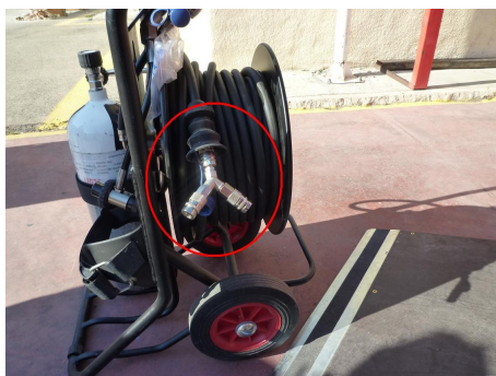
Figuras 2, 3 y 4.- Conector “Y” acoplado a la devanadera, manguera individual, válvula ASV conectada.
