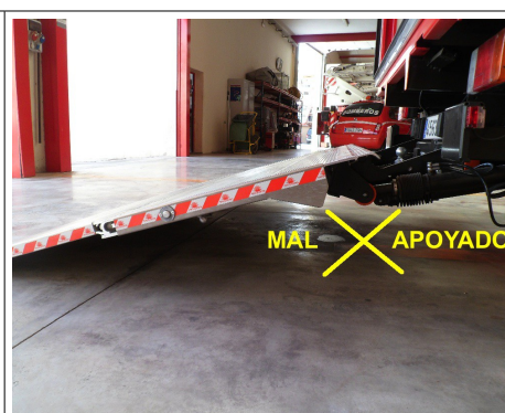
Figura 7.- Apoyo incorrecto (rampa)
