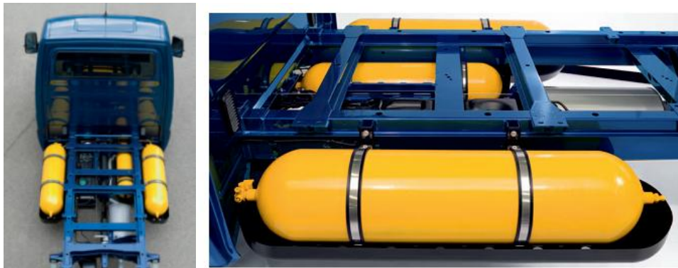
Figura 13. Distribución de circuito de gas en el microbús.
