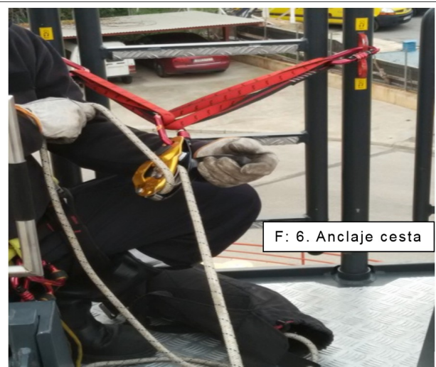
Figuras 5 y 6.- Anclajes de la línea de seguridad en la escalera y en la cesta.
