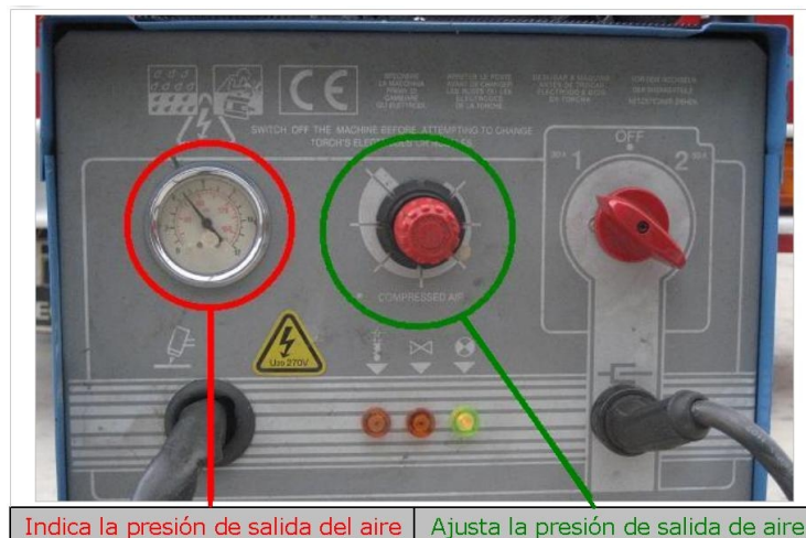
Figura 3.- Manómetro de control y válvula reguladora de presión de aire.
