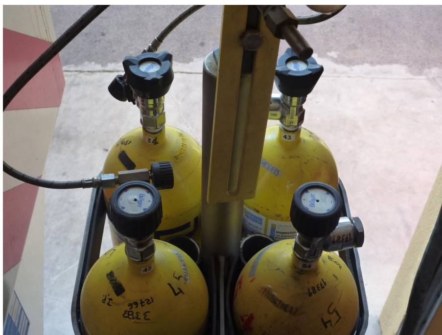
Figura 3.- Batería de botellas (a la izquierda botellas conectas listas para su uso).
