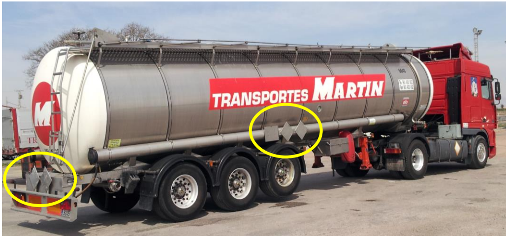
Figura 4. Cisterna vacía, limpiada y desgasificada. Como puede observarse, no lleva paneles naranja ni placas etiqueta (círculos amarillos).
