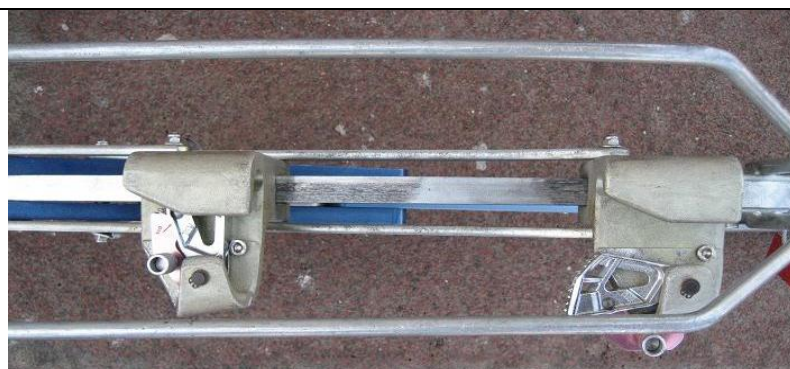
Fig.15. Parte inferior del torno en donde se observan las dos mordazas (una abierta y la otra cerrada).
