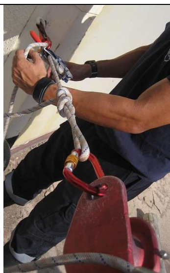
Fig.12. Intercalado de línea con descensor entre punto de anclaje y torno.
