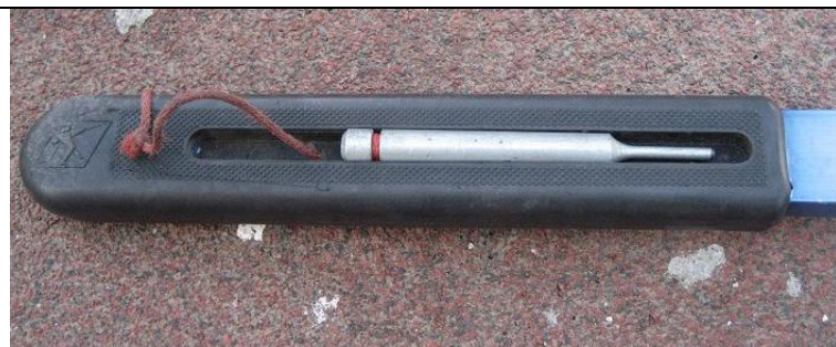
Fig. 8. Detalle del puntero para extraer el pasador de seguridad, y que va insertado en un lateral de la empuñadura de la palanca de accionamiento.
