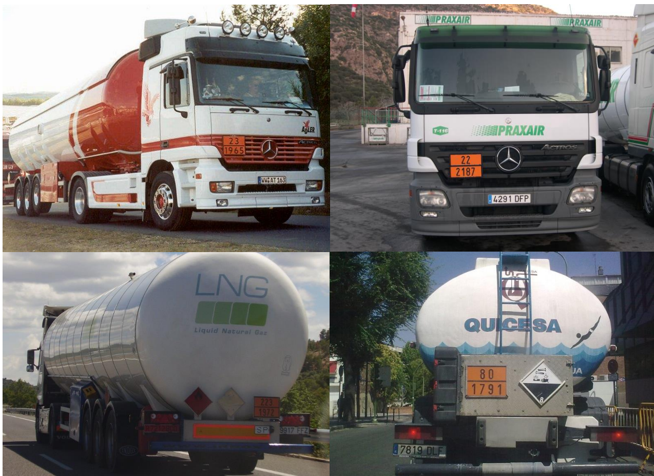
Figura 3. Colocación de paneles naranja en unidades de transporte con una sola mercancía.
