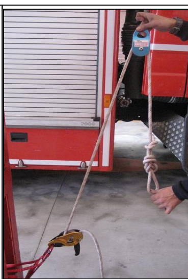
Figura 13. Esquema de la línea de aseguramiento.
