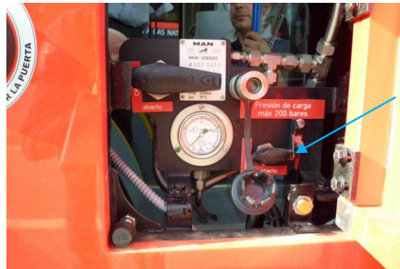
Figura 14. Llave de cierre de paso de gas al motor.
