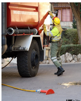
Figuras 7, 8 y 9.- Secuencia de la protección mediante formador de cortina/apantallador.
