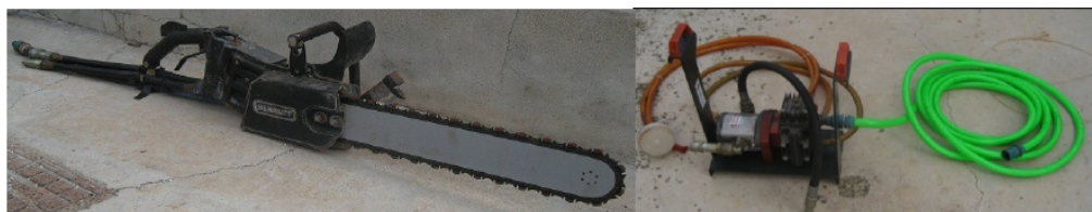
Figuras 6 y 7. Sierra de cadena diamantada y bomba de agua con sus mangueras.
