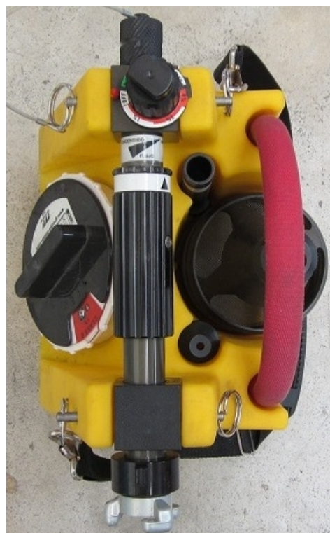
Figuras 1 y 2. Vista frontal y superior de la unidad portátil de espuma multiexpansión (PROPAK)
