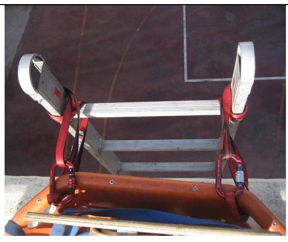
Fig. 10. Vista de cómo quedaría finalmente la unión de la escalera y la camilla.
