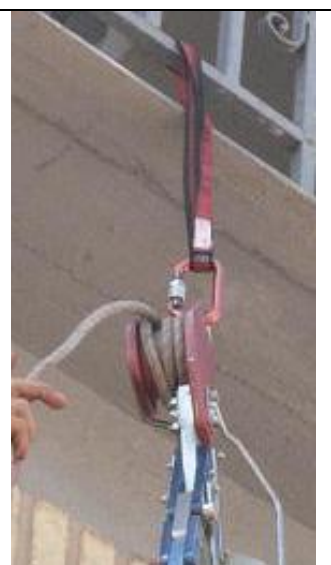
Fig 10. Ampliación del tambor circular con las 4 vueltas de cuerda.
