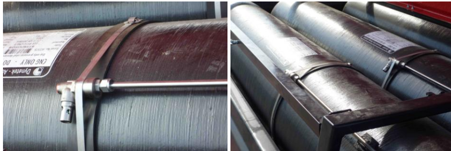
Figura 5. Vista del termofusible (izquierda)
