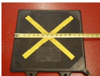
Figura 3. Reducción de superficie de trabajo de los cojines de alta presión al ser inflados.
