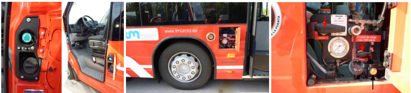
Figura 8. Unidad de repostado del microbús (izquierda) y autobús (derecha).
