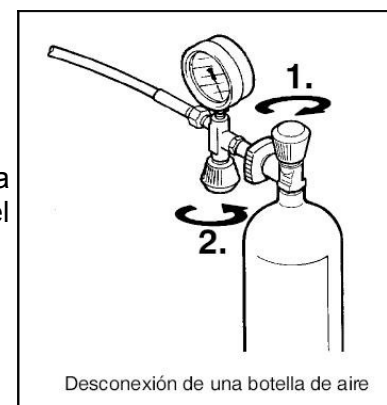
Figura 10- Secuencia de cierre de válvulas para la desconexión de una botella.
