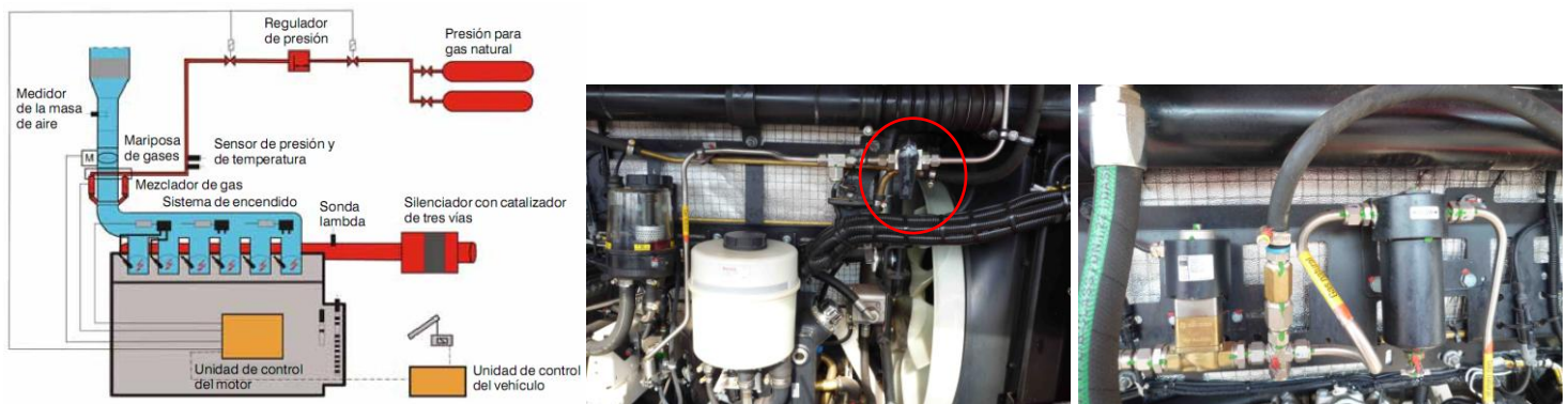
Figura 7. Esquema de funcionamiento del motor de gas natural comprimido (autobús). En rojo la válvula de entrada de gas.
