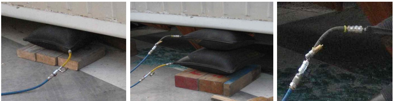
Figura 5 (a, b, c). Elevación de cargas con cojín único (a), cojines apilados (b), válvula de retención (c).
