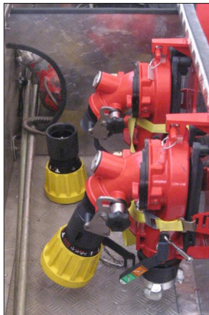
Monitores plegados en arcón superior del vehículo
