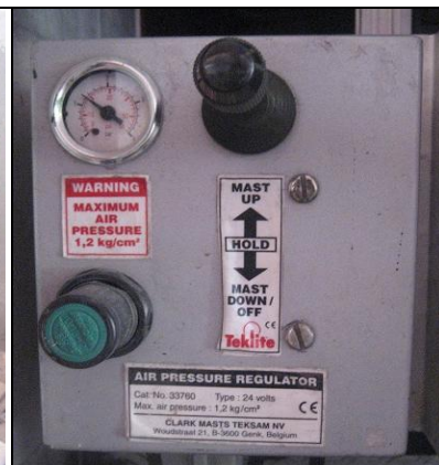
Figura 25. Detalle del control del mástil telescópico del vehículo BT-4.
