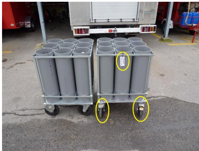
Figuras 26 y 27.- Puntos de frenado, anclaje o advertencia de los carros de botellas.
