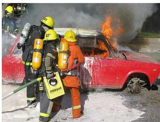
Figura 3. Extinción de incendio en vehículo mediante PROPAK
