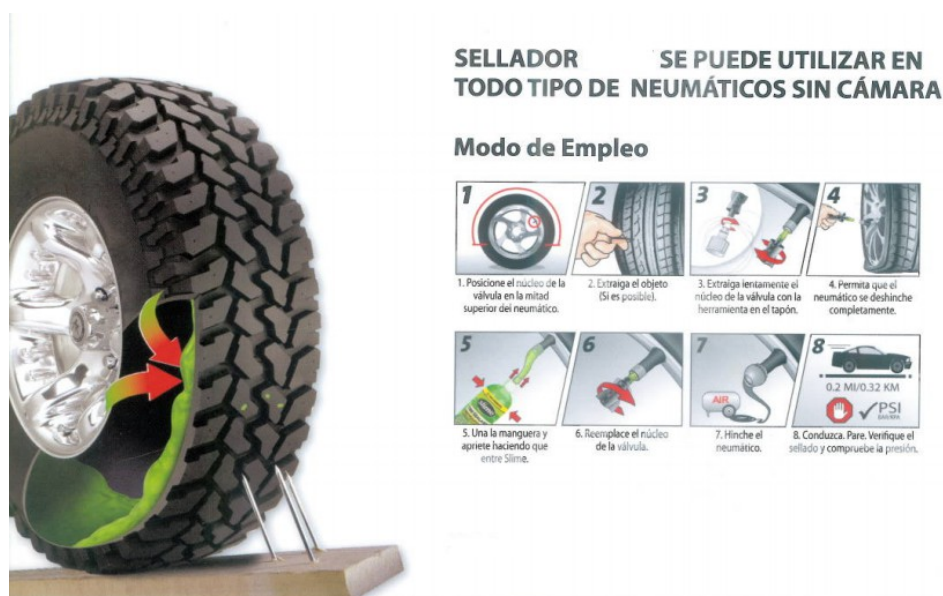
Figura 3.- Resumen del modo de empleo del sellador de pinchazos.
