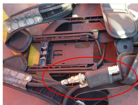
Figuras 2, 3 y 4.- Conector “Y” acoplado a la devanadera, manguera individual, válvula ASV conectada.
