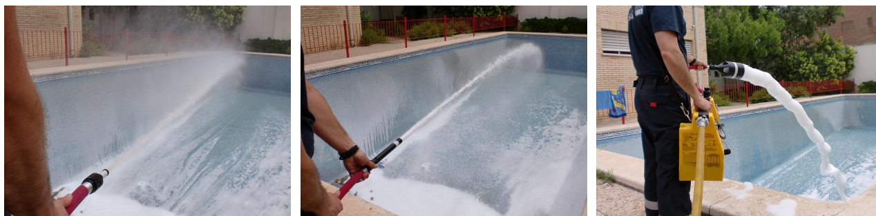
Figuras 8, 9 y 10. Diferentes tipos de chorro de espuma.
