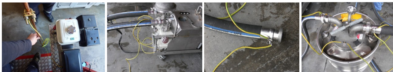
Figura 7. Conexiones a tierra (generador, bomba, mangueras y depósito).
