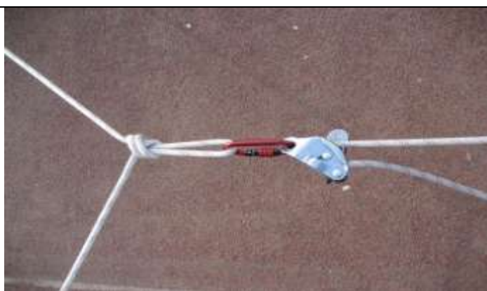
Figura 10. Línea que asegura la camilla y que se fijó a dos puntos distintos, para que la tracción estuviese alineada con la zona de trabajo.
