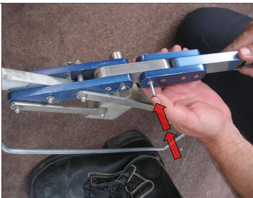
Fig.6. Colocación del pasador de seguridad.
