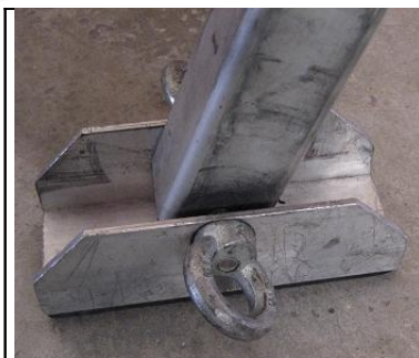
Figura 5. Detalle de apoyo de la pata del trípode.
