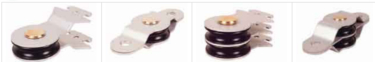
Figura 2. Poleas con las que va equipado el sistema. Las dos de la izquierda son las poleas simples ya instaladas en el equipo. Las de la derecha son las poleas dobles que, llegado el caso, nos permitirían obtener una mayor VM (5:1).
