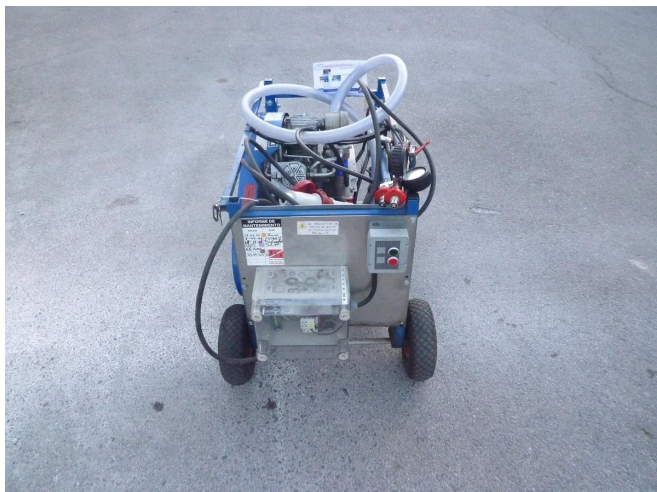
Figuras 1, 2, 3 y 4.- Diferentes vistas del compresor “Mariner II” del S.E.I.S.
