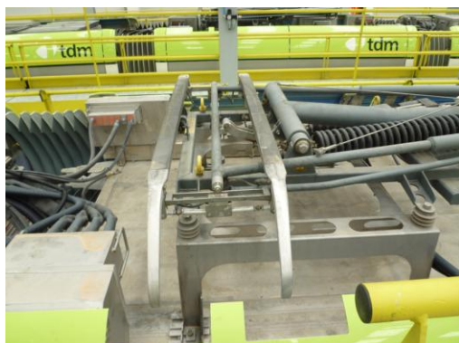
Figura 12. Vista general del pantógrafo (i) y ubicación de aisladores (d).
