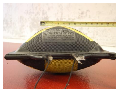
Figura 3. Reducción de superficie de trabajo de los cojines de alta presión al ser inflados.
