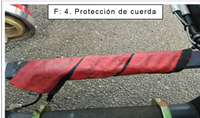
Figura 4.- Detalle de la protección de cuerda instalada en el último peldaño de la escalera.
