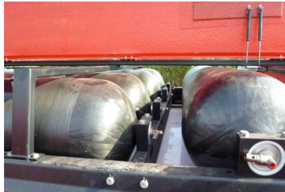
Figura 0.- Cilindros de gas instalados en un autobús GNC.
