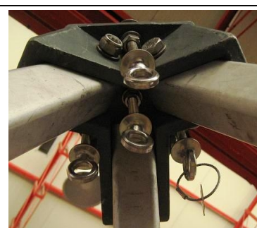
Figuras 7. Parte superior del trípode, con anillas de fijación (vista desde abajo).
