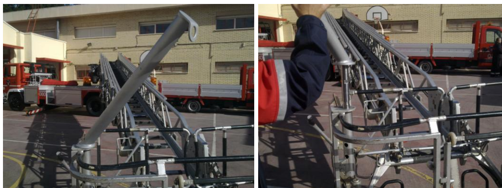
Figura 1. Sistema de anclaje seguro para autoescala Magirus (E-9).
