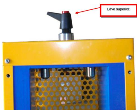
Figura 4.- Detalle de la llave de sujeción y cambio del útil superior.
