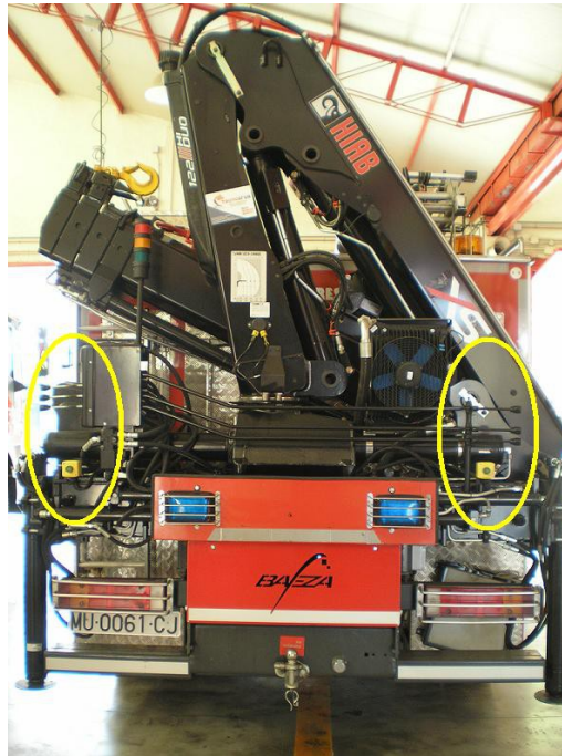
Figura 0.- Pulsadores y palancas para despliegue y recogida de apoyos en el PS-25
