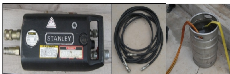
Figuras 8, 9 y 10. Intensificador de presión, mangueras hidráulicas y depósito de agua.
