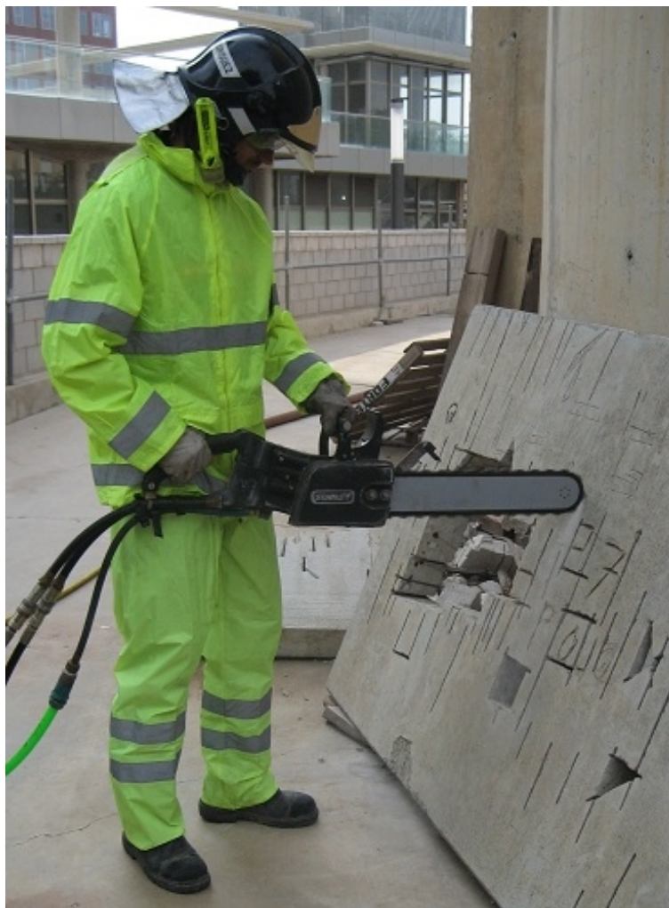
Figura 1.- Bombero trabajando con el equipo de corte de hormigón Stanley DS-11
