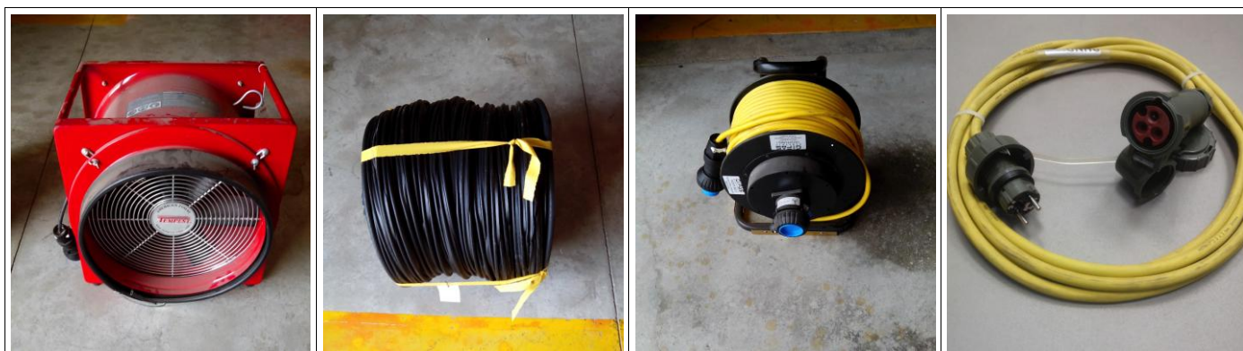
Imagen 2, 3, 4 y 5.- Ventilador, conducto de evacuación, devanadera eléctrica, adaptador.
