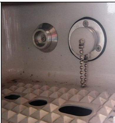
Figura 24. Detalle de alimentación del foco frontal en vehículos C-28 y C-29.
