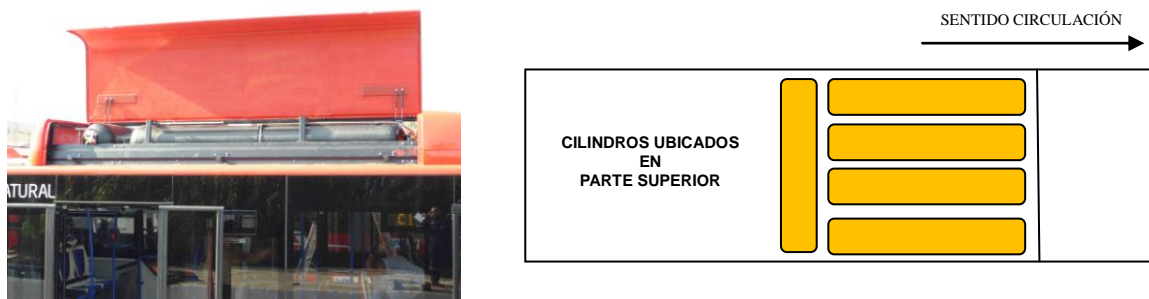
Figura 1. Disposición de las botellas de gas en el techo.
