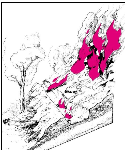
Figura 5. Trincheras para impedir la propagación por rodadura.
