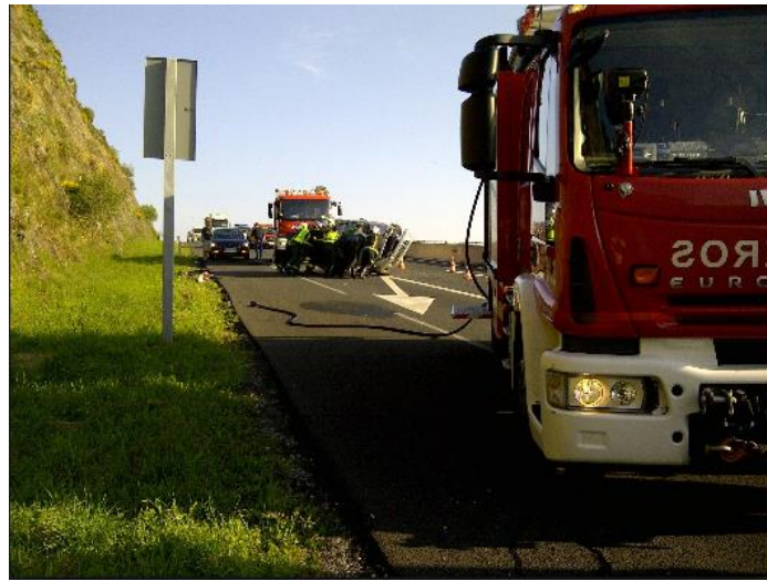
Figura 0: Protección de la zona caliente con el BUP y FSV
