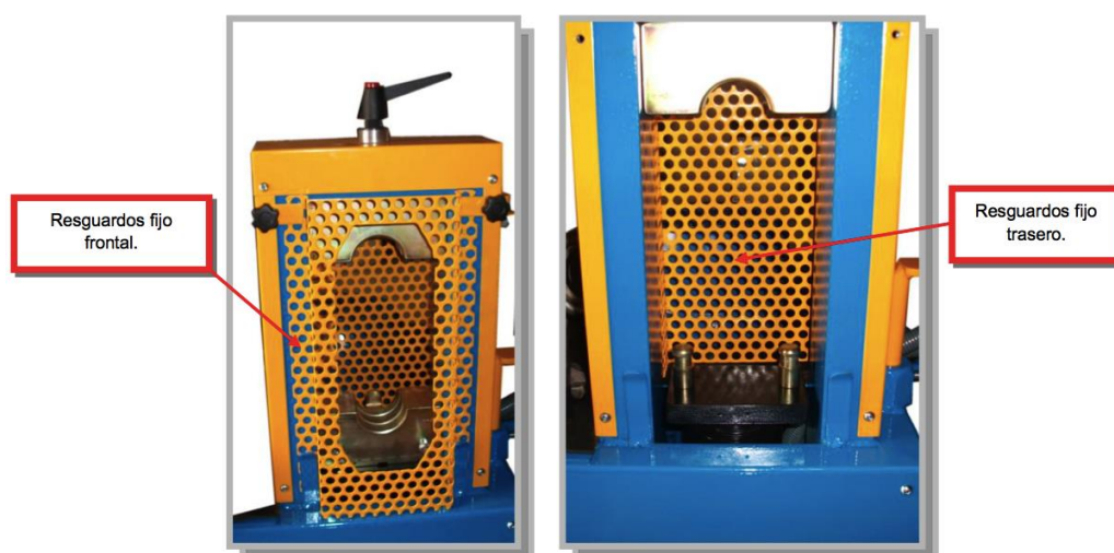
Figuras 8 y 9.- Resguardos fijos frontal (extraíble) y trasero.
