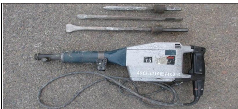
Figura 4. Equipo BOSCH USH-10 con sus tres punteros.
