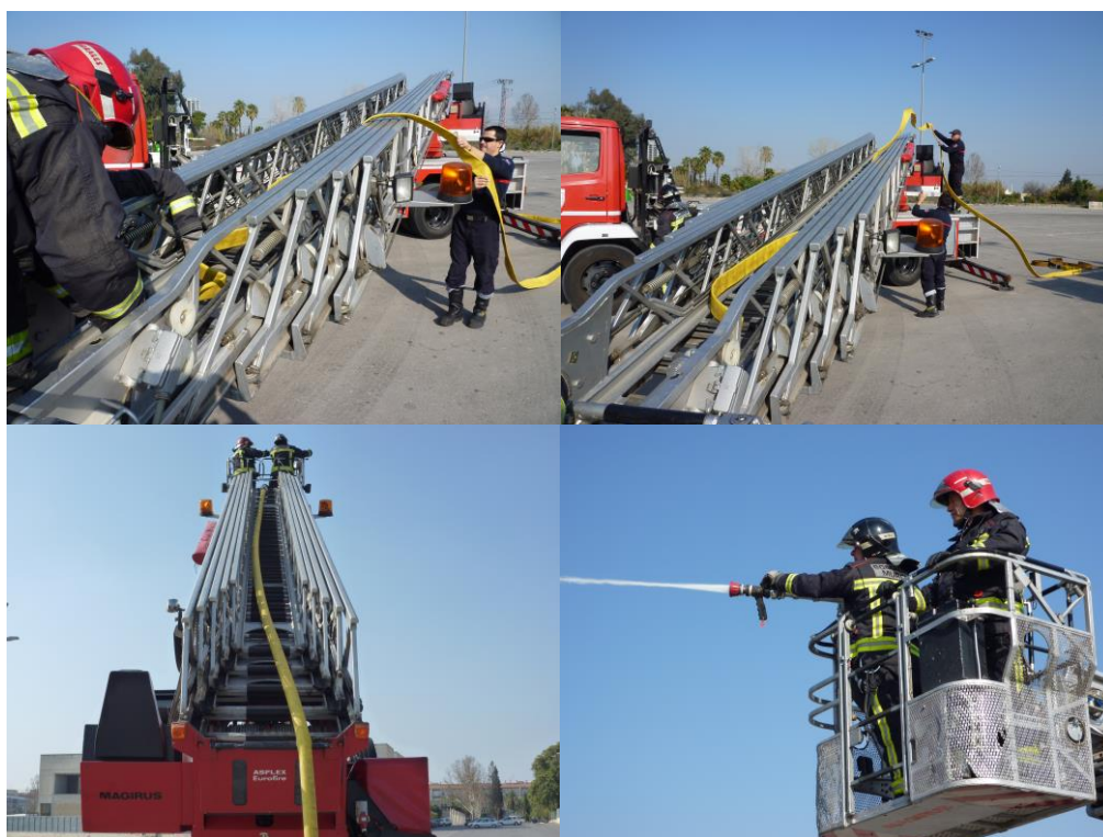
Figura 3. Secuencia de instalación del tendido y lanzamiento de agua.
