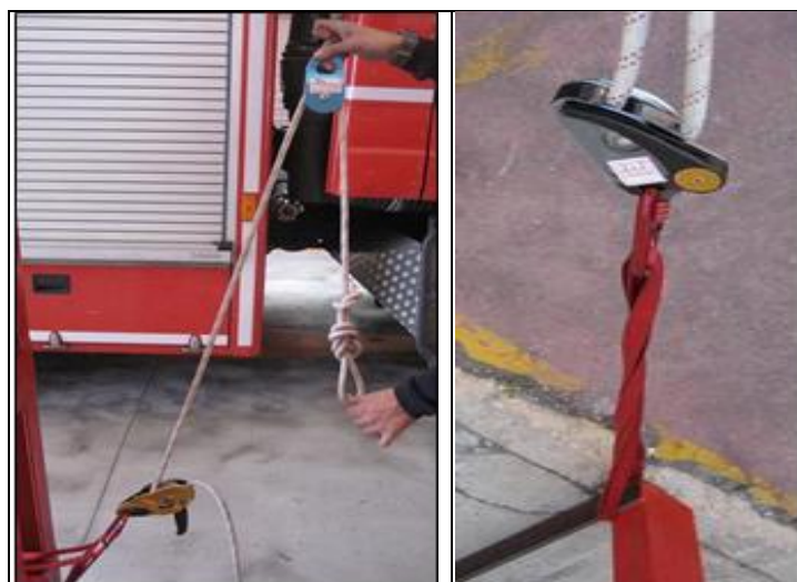
Figura 6. Esquema de línea de aseguramiento (izquierda). Detalle de polifreno (derecha).
