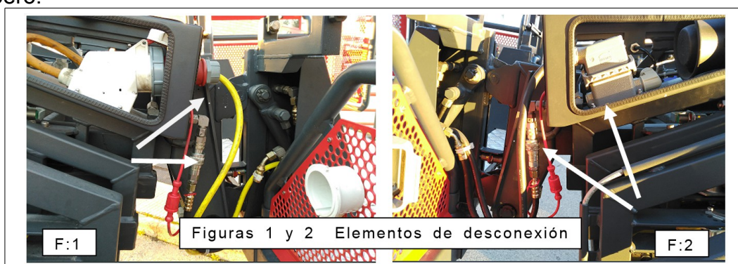
Figuras 1 y 2. Elementos de desconexión del cesto
