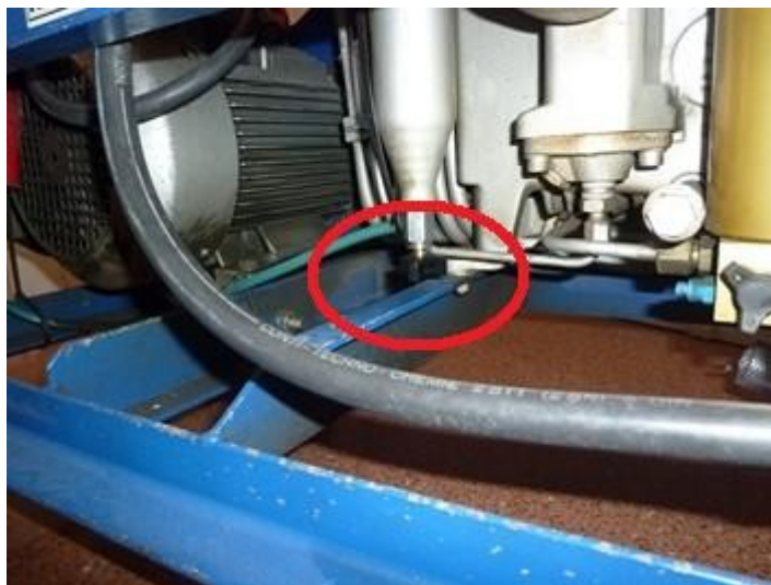
Figura 9- Válvula del drenaje del decantador.
