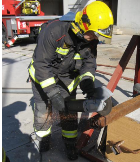
Figura 1. Corte de perfil metálico mediante amoladora.
