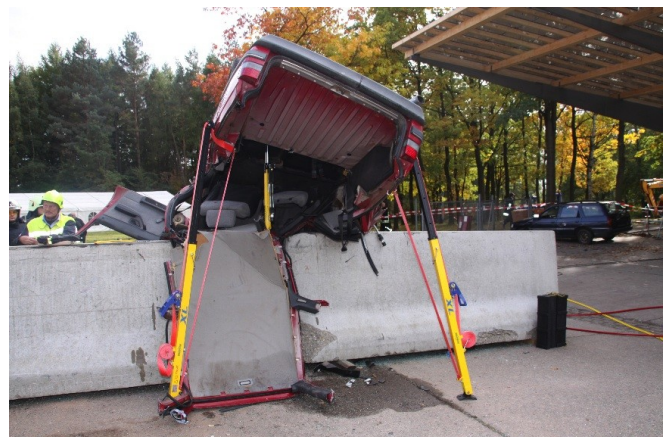
Figuras 11, 12 y 13.- Ejemplos de estabilización de vehículos en posiciones poco habituales.
