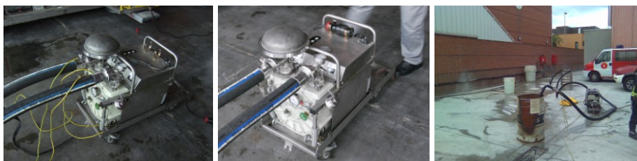
Figura 11. Instalación de la bomba peristáltica.
