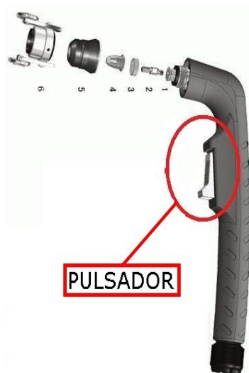
Figura 7.- Despiece de la torcha y ubicación del pulsador.
