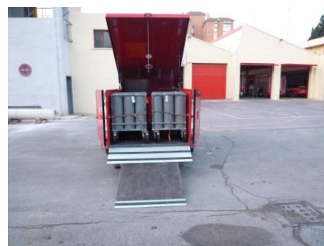
Figuras 14, 15, 16, 17, 18 y 19.- Secuencia de despliegue de las rampas.
