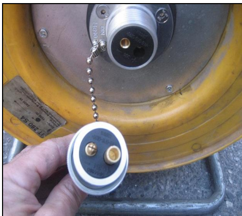
Figura 23. Detalle de clavijas de conexión de la devanadera del foco frontal.
