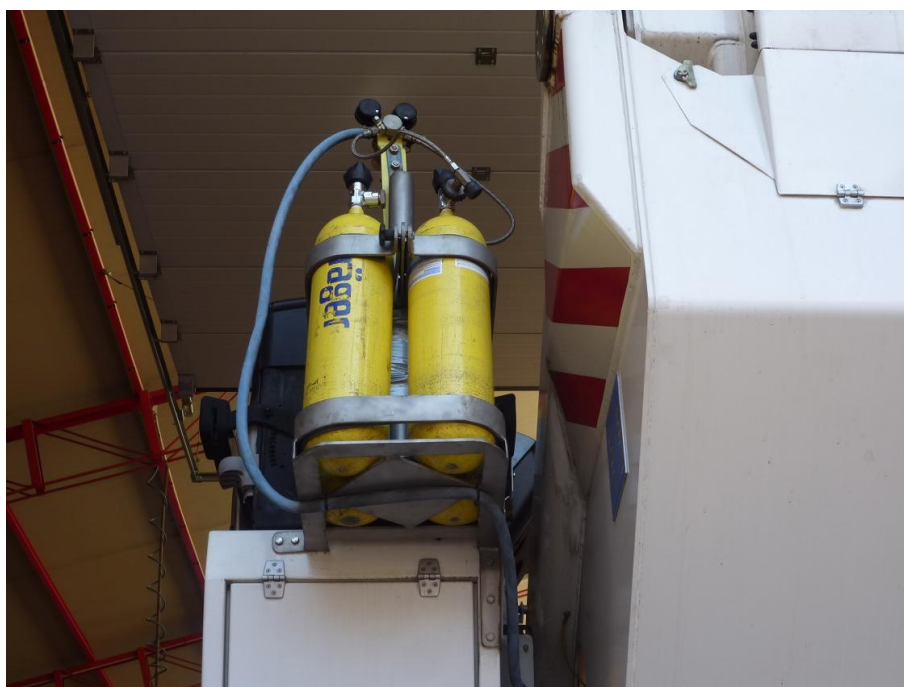
Figura 2.- Detalle de la instalación fija (soporte de botellas y conducción de aire).
