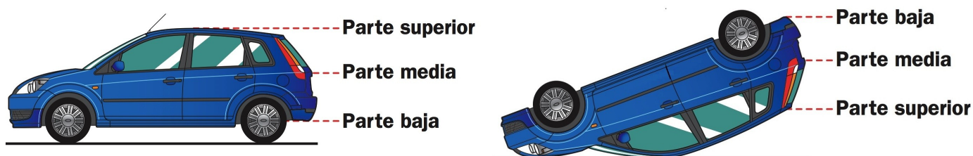
Figuras 2 y 3.- Denominación de las partes de un vehículo en función de su altura.
