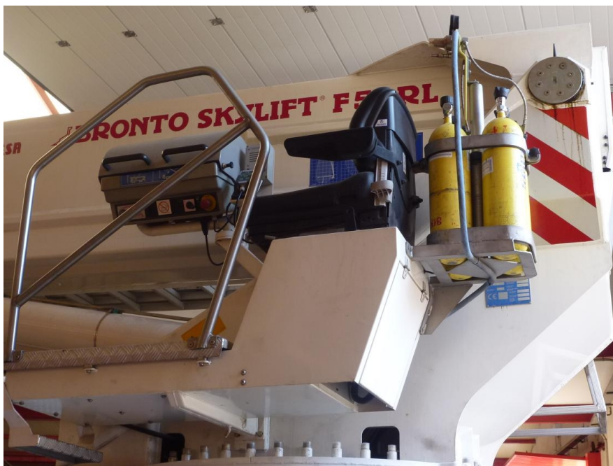
Figura 1.- Equipo de suministro de aire instalado sobre el BE-26.
