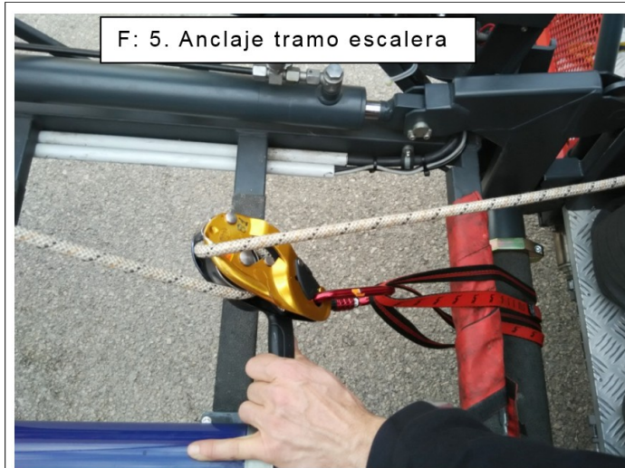
Figuras 5 y 6.- Anclajes de la línea de seguridad en la escalera y en la cesta.
