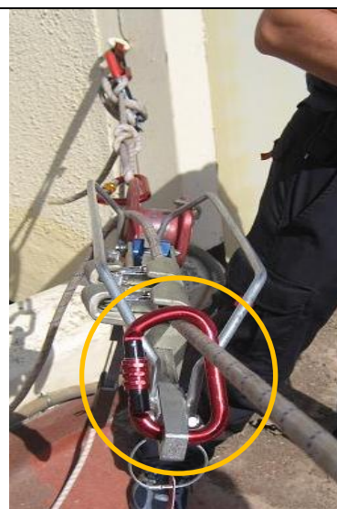
Fig.13. Se observa el mosquetón unido al torno y por el que pasa la cuerda.
