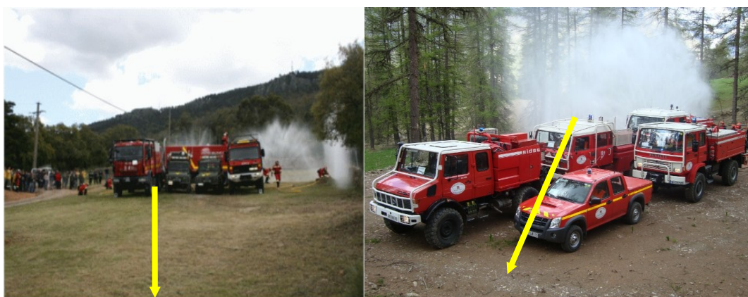
Figura 18. Maniobra de autoprotección perpendicular y oblicua a la propagación del incendio.
