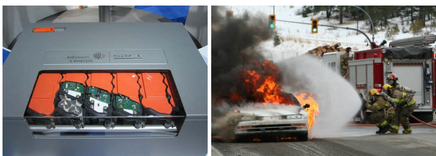
Figura 20. Corte de una batería de NiMH e incendio de vehículo eléctrico.
