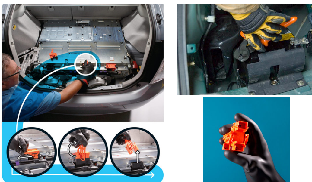
Figura 19. Desconexión de la batería e interruptores de servicio.
