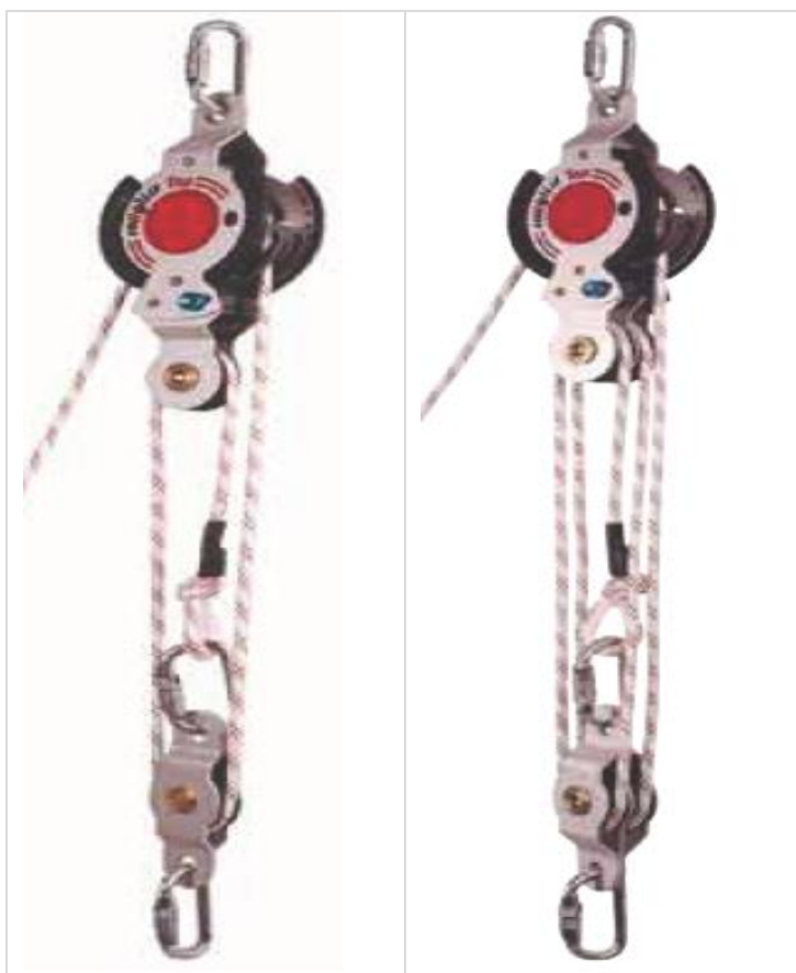
Figura 3. Configuración estándar (izquierda) con VM 3:1. A la derecha observamos la configuración en la que la VM es 5:1.
