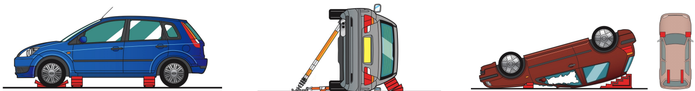
Figuras 8, 9 y 10.- Estabilización de vehículos en las tres posiciones más habituales.
