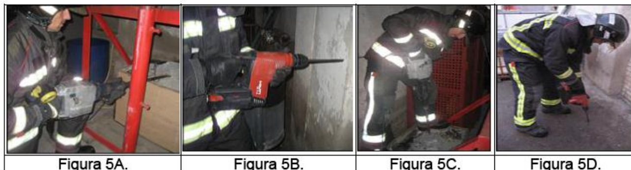
Figura 5. Se observa el uso de las herramientas tanto en paramento vertical (5A, 5B), como en paramento horizontal (5C, 5D).
