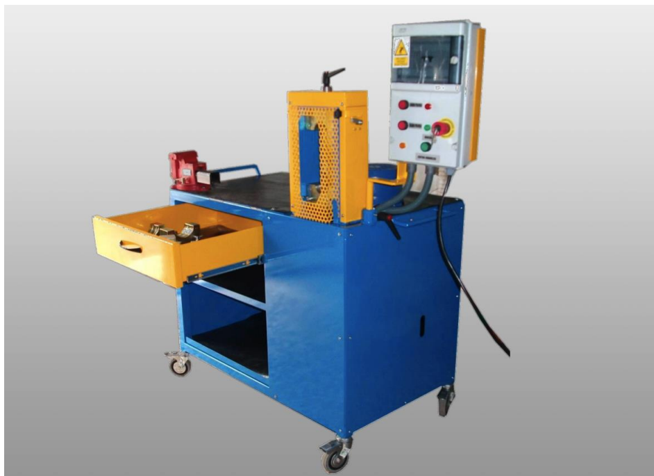
Figura 0.- Vista general de la máquina de racorar.
