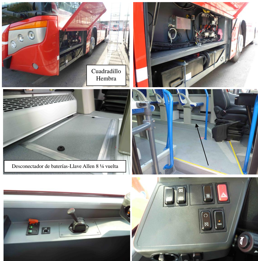
Figura 10. Ubicación de baterías, desconector de baterías, desconexión de sistema eléctrico e interruptor de arranque.
