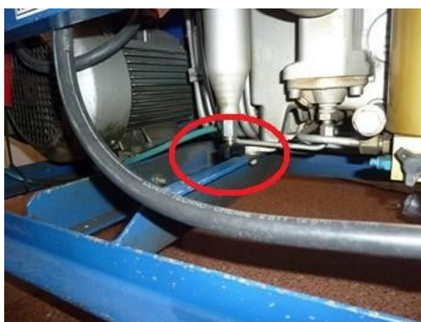
Figura 12- Válvula del drenaje del decantador.
