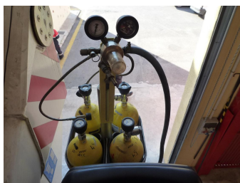
Figuras 8, 9, 10 y 11.- Batería de botellas, conexiones en cesta, caja de equipos y E.R.A.'s convencionales.
