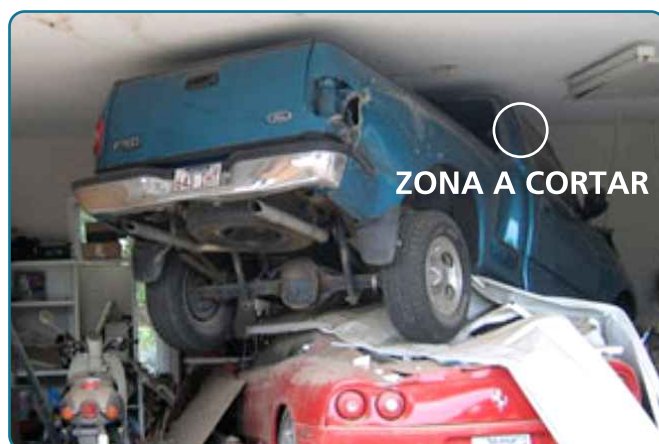
Figura 7. Corte en un plano superior.
