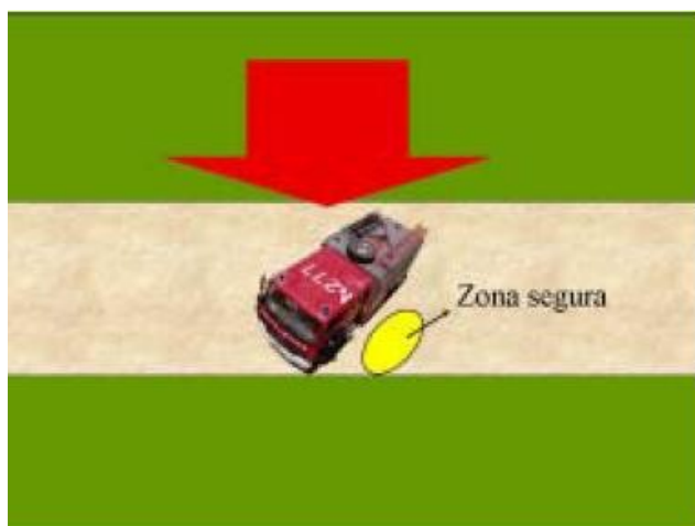
Figuras 5 y 6.- Posiciones correcta/incorrecta respecto al frente del incendio.
