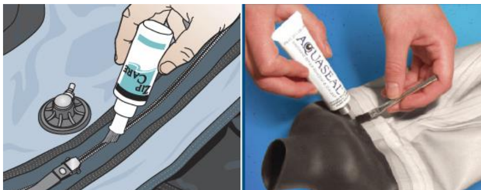
Figuras 5 y 6. Lubricado de cremallera (izqda.) y reparación de manguito (dcha).
