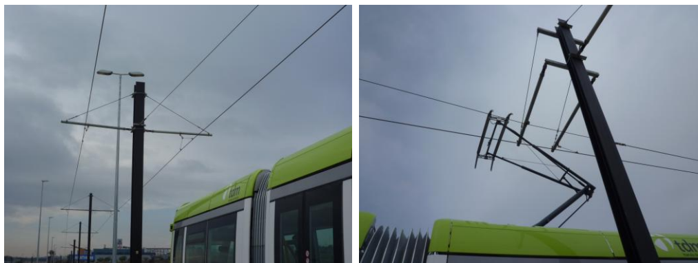
Figura 1 y 2. Catenaria (izquierda) y pantógrafo (derecha).
