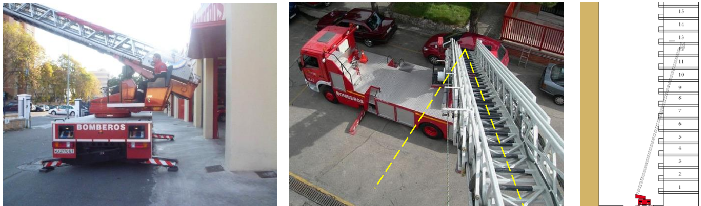
Figura 7. En la izquierda, AEA operando alineada con el objetivo. En el centro, AEA trabajando desalineada.
