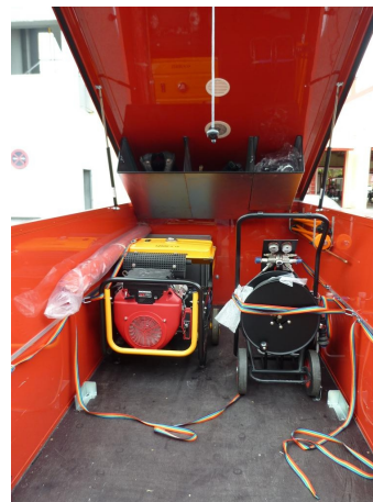
Figuras 9 y 10.- Ubicación del equipo en el remolque Unidad de Reserva de Aire.
