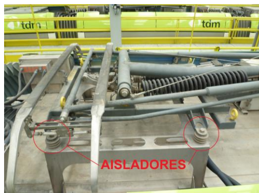
Figura 12. Vista general del pantógrafo (i) y ubicación de aisladores (d).
