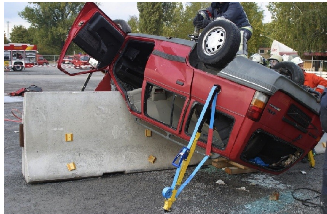
Figuras 8, 9 y 10.- Estabilización de vehículos en las tres posiciones más habituales.
