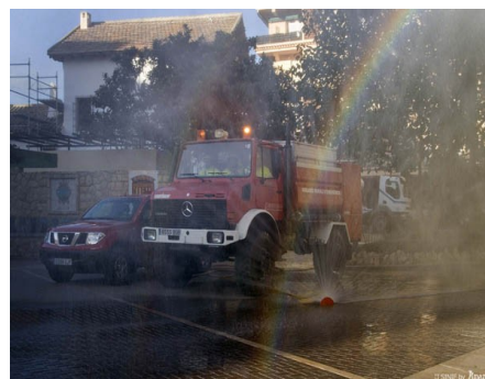
Figuras 7, 8 y 9.- Secuencia de la protección mediante formador de cortina/apantallador.
