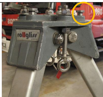
Figura 6. Parte superior del trípode, con anillas de fijación (vista lat.)
