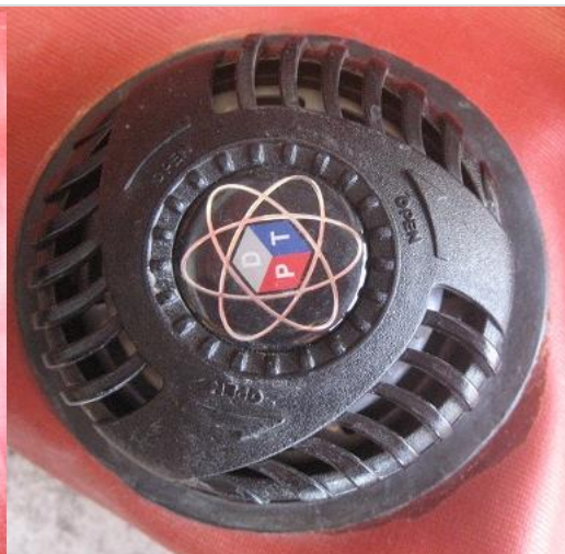
Figura 8. Detalle de válvula de purga, sita en brazo izquierdo.
