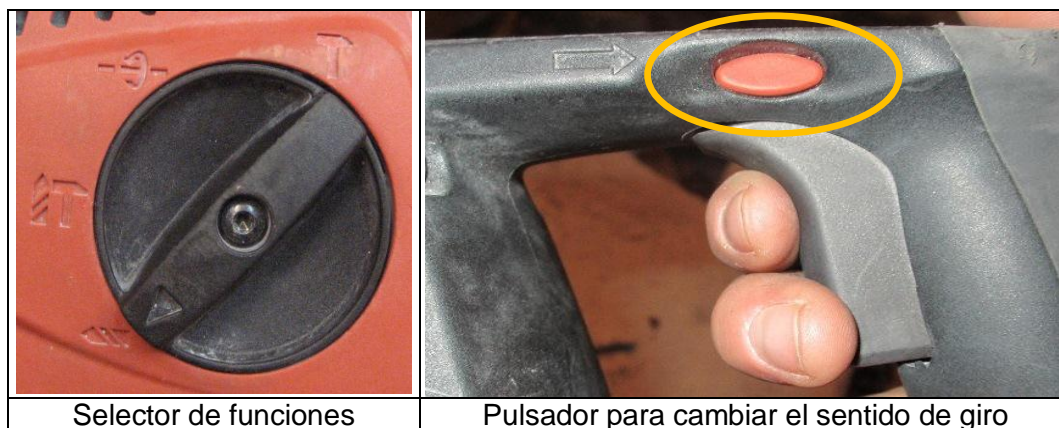
Figura 3. Palanca selectora y pulsador selector de sentido de giro.
