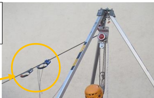
Figura 15. Cuerda de tracción, en donde se han colocado dos bloqueadores de puño, para facilitar la maniobra.
