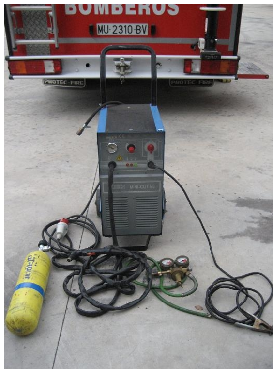
Figura 2.- Equipo de corte por plasma MINI-CUT 55 y elementos auxiliares
