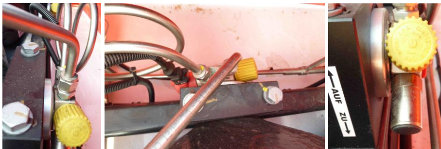
Figura 3. Vista de la valvulería en el cilindro (autobús). En rojo electroválvula. Válvula de exceso de flujo (tapón negro).
