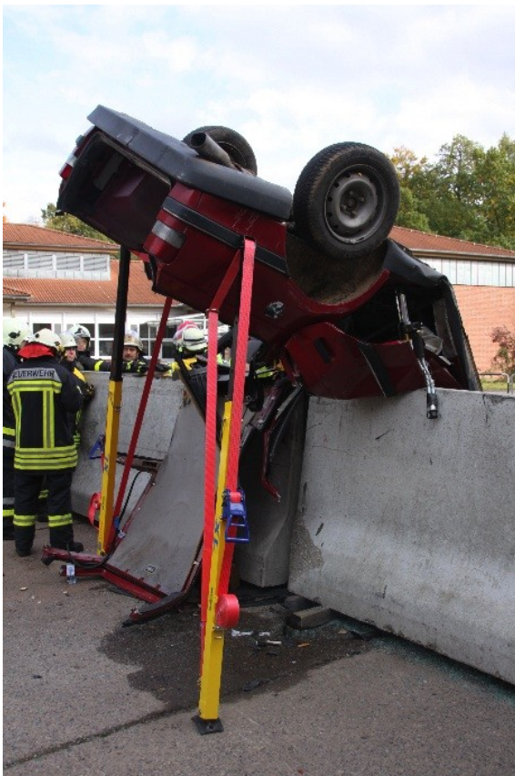
Figuras 11, 12 y 13.- Ejemplos de estabilización de vehículos en posiciones poco habituales.
