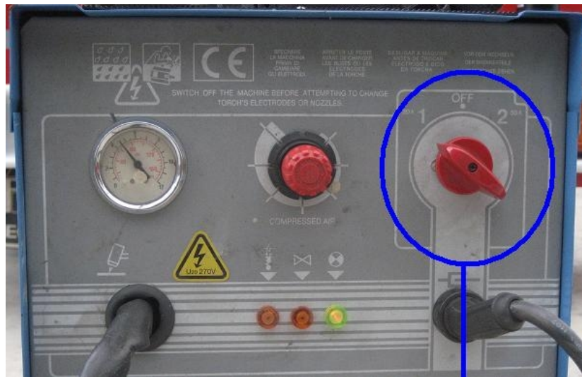
Figura 6.- Selector de potencia de trabajo de 3 posiciones (1 – OFF - 2).
