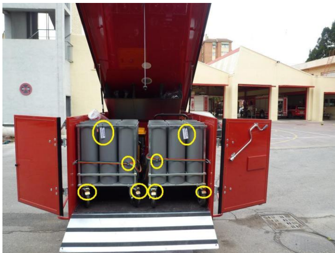
Figuras 26 y 27.- Puntos de frenado, anclaje o advertencia de los carros de botellas.
