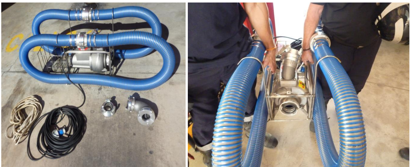
Figura 2. Elementos que integran el conjunto de bombeo y posición de transporte del bastidor.
