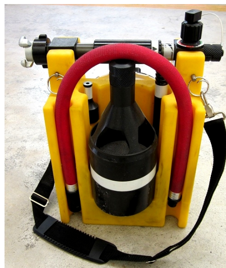
Figura 5. Ubicación de las lanzas en el equipo
